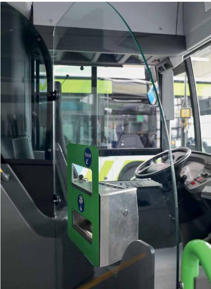
In den AVV-Bussen wurden unter anderem eine vollflächige Scheibe im Eingangsbereich mit integriertem Münzwechsler montiert.
