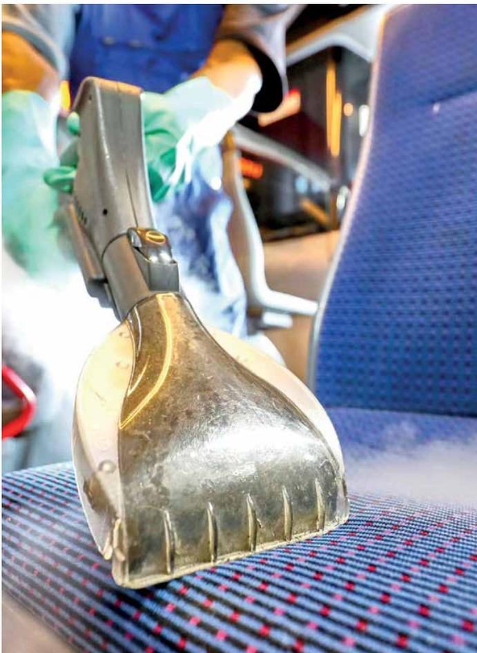
Die Dampfsaugsysteme der beam GmbH inaktivieren nicht nur die Viren auf Oberflächen, sondern reinigen auch gleich die Raumluft.
